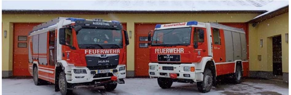
ist auf ein 18t Fahrgestell (TGM 18.320 4x4) der Marke MAN aufgebaut. Der feuerwehrtechnische Aufbau erfolgte vom Feuerwehrausrüster Rosenbauer in Leonding bei Linz. Angetrieben wird das Fahrzeug von einem Dieselmotor mit 235 KW und Automatikgetriebe. Der Löschwassertank fasst 4000 Liter. Ein Dachwasserwer-
